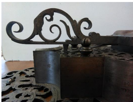
Obr. 9. Přesah pákové kliky shodný u originálního zámku i jeho kopie (foto autorka 2016).
