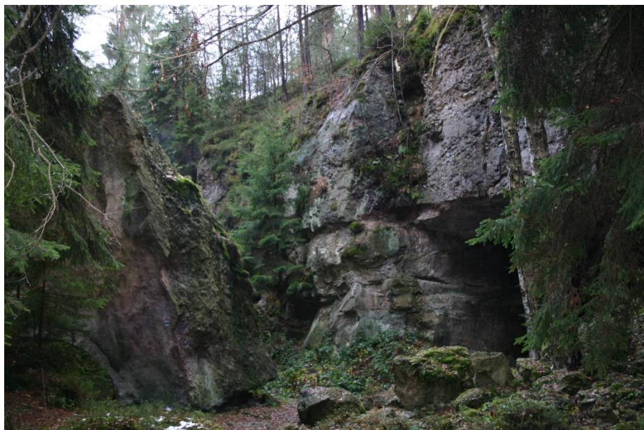
Obr. 3. Část lomů Nad Planinou na Janově dokumentuje hornický způsob dobývání arkózy vlastně hornickou metodou, dobývka probíhala v téměř vodorovných štolách. Foto Petr Ježek, 2011.
